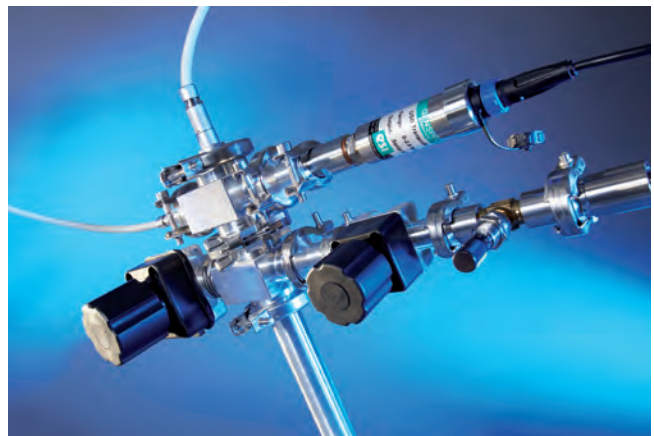
Der Hochtemperatur-Hall-Messplatz von Fraunhofer IPM bestimmt bei Temperaturen von 20 – 650 °C die Anzahl, Art und Beweglichkeit der Ladungsträger in Halbleitern.
