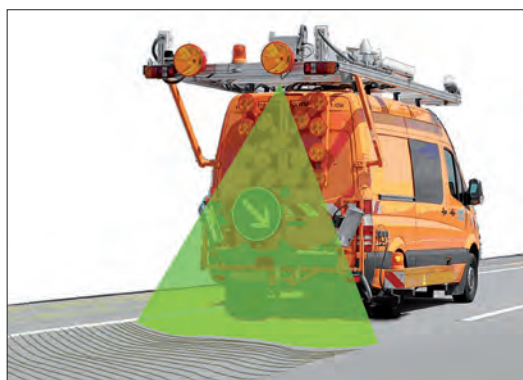
Ein einziger Laserscanner misst das Querprofil der Fahrbahn auf einer Breite von vier Metern. Mit 800 Profilen pro Sekunde erreicht er eine hohe Genauigkeit.
