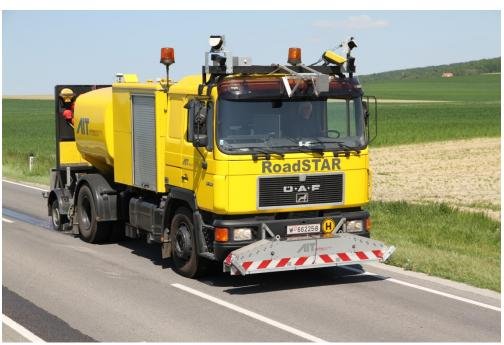
Der RoadSTAR prüft seit 1991 Österreichs Straßen, seit 2013 ist er mit dem Messsystem PPS unterwegs. Der Laserscanner wird an der Stirnseite des Messfahrzeuges angebracht. ©AIT Austrian Institute of Technology GmbH; Bildquelle in Farbe und Druckqualität: www.ipm.fraunhofer.de
