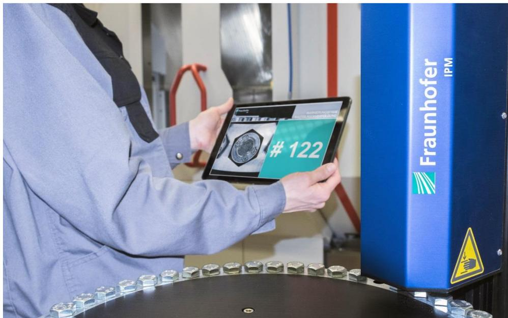
**Fraunhofer IPM hat mit »Track & Trace Fingerprint« ein markerfreies System zur Rückverfolgung von Massenbauteilen entwickelt. © Fraunhofer IPM**
