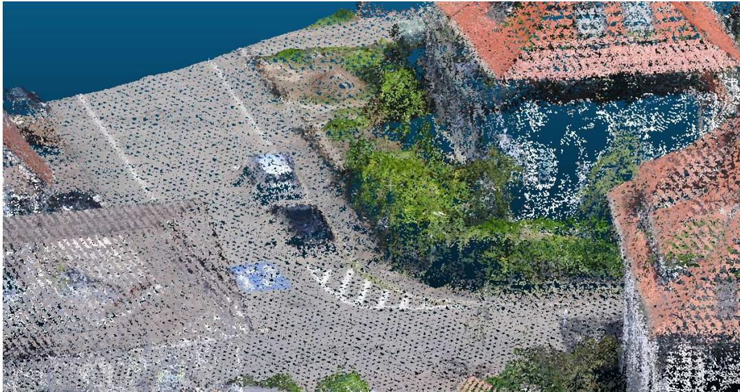
**Abbildung 8: Ausschnitt einer Punktwolke, welche Rauschen an Mauern und Bordsteinen, durch unkenntliche Strukturen, zeigen soll.**
