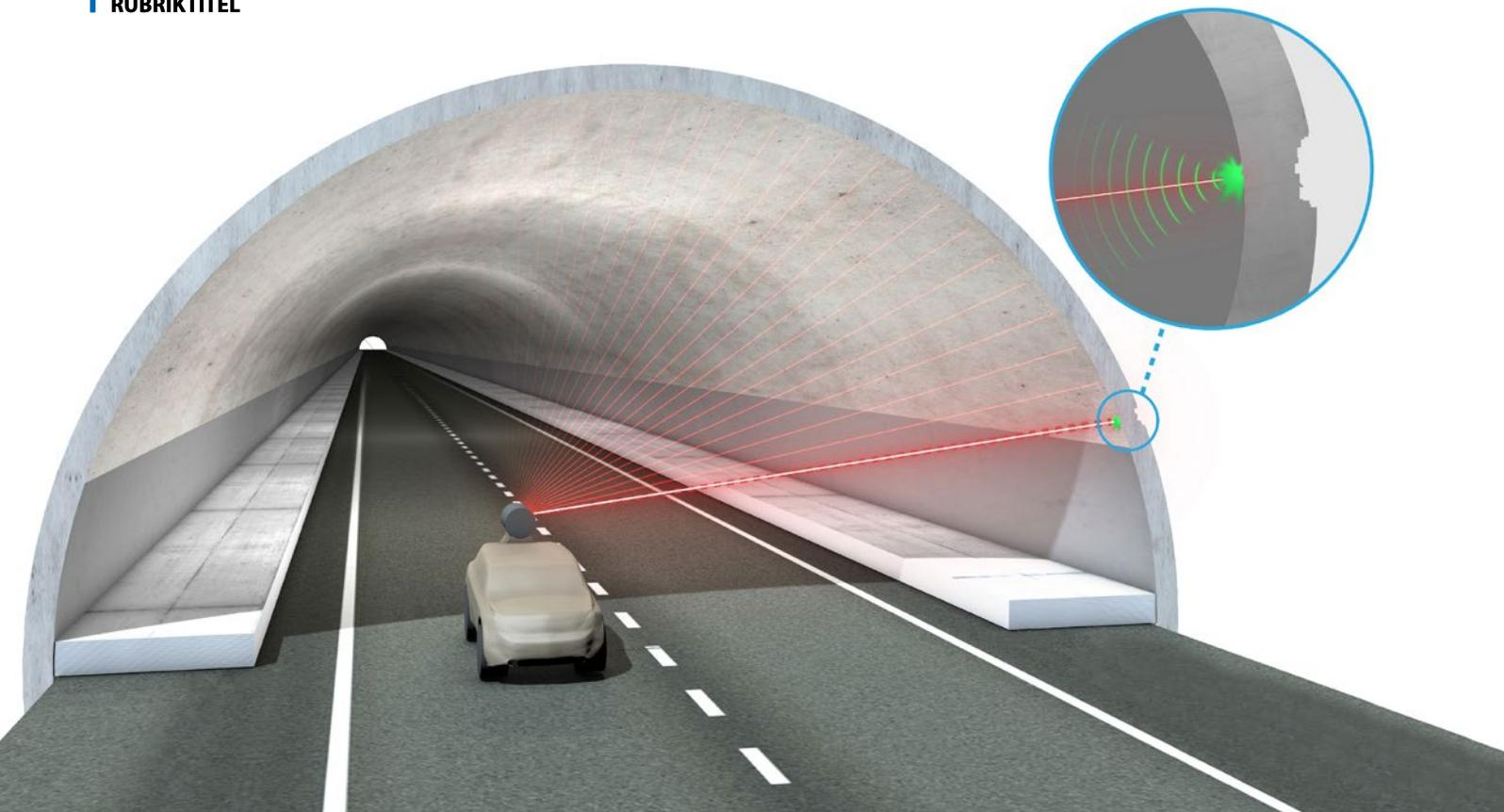
**Titelbild:** Schäden an Tunnelwänden verbergen sich mitunter unter der Oberfläche. Mit laserinduziertem Körperschall lassen sich diese Fehlstellen automatisiert aufspüren – genauer als dies mit der heutigen Hammerschlagmethode möglich ist.
