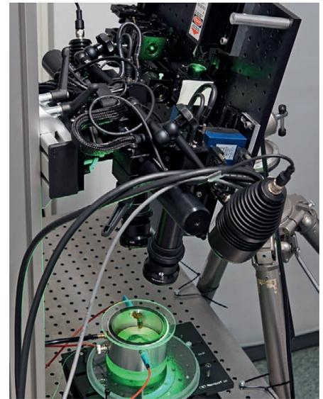
**Bild 6:** Laborsystem zur Form- und Verformungsmessung bei thermischer Beanspruchung
