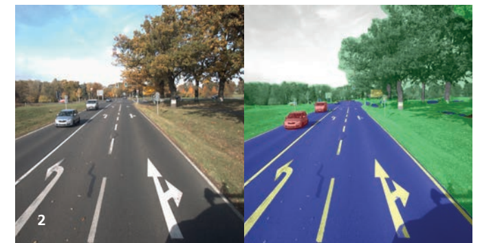
1 Straßenobjekte in Messdaten erkennen, klassifizieren und lokalisieren ist aufwändig. Mustererkennung auf Basis künstlicher neuronaler Netze automatisiert den Prozess.
