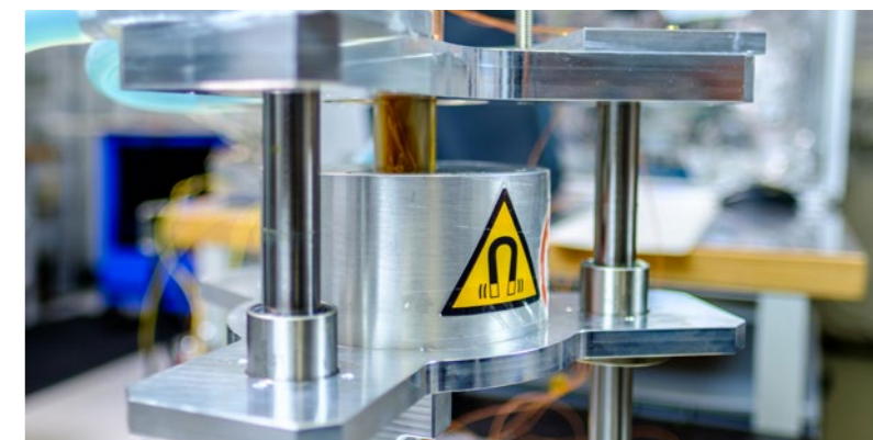
Mit magnetokalorischen Materialien lässt sich ein Kühlzyklus realisieren. Fraunhofer IPM besitzt ein wichtiges Patent, um diesen Kühlzyklus besonders schnell durchlaufen zu können.
