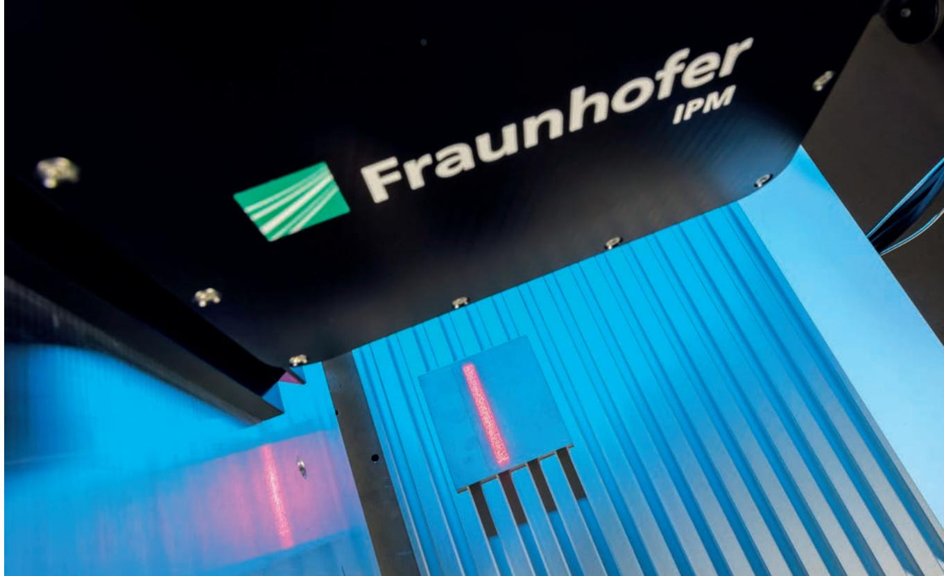
*Der R-Imager leitet die Oberflächenrauheit aus Speckle-Mustern ab, die von zwei kohärenten Lasern unterschiedlicher Wellenlänge erzeugt werden.*
