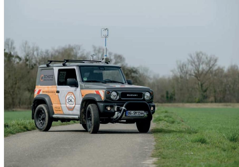
Ein laserbasiertes photoakustisches Messsystem im Messfahrzeug saugt Umgebungsluft an. So wird geprüft, ob Erdgas aus unterirdischen Leitungen entweicht.
