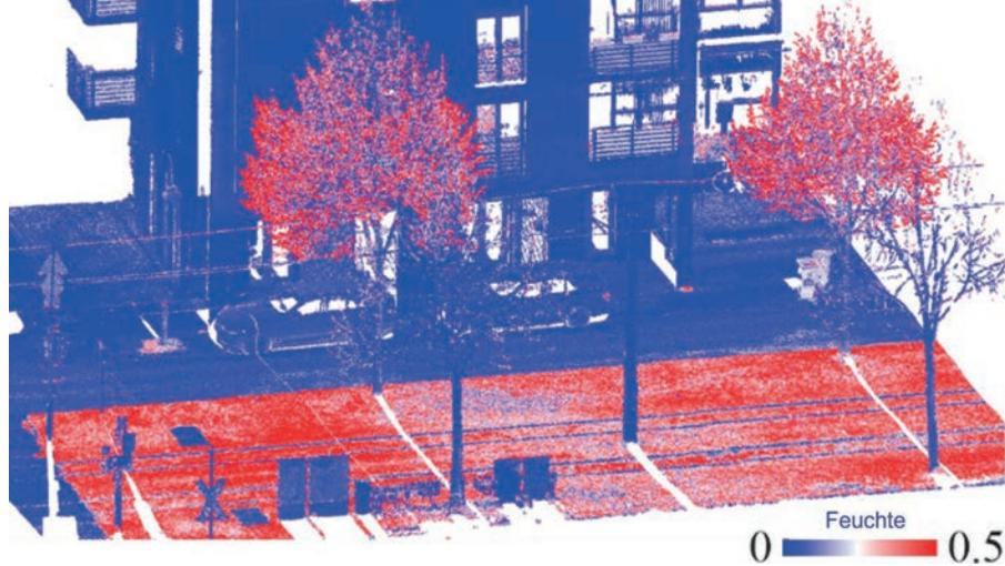
*Multispektrale Laserscans zeigen den Feuchtegehalt (hier rot) von Boden und Bäumen an und ermöglichen somit Aussagen über die Baumvitalität.*
