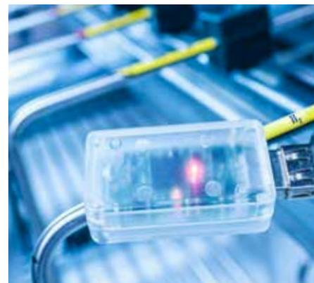
*Klein und sparsam: Der nur 6×2 cm<sup>2</sup> große H<sub>2</sub>-Sensor lässt sich an einen PC anschließen und misst die H<sub>2</sub>-Konzentration ab 0,4 Prozent in Luft in weniger als einer Minute.*
