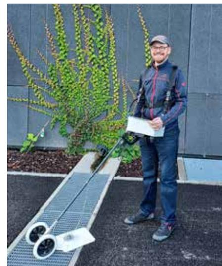
*Lecks auf der Spur: Tobias Kolleth mit dem mobilen, photoakustischen Methan-Detektor, der im Projekt RedFinch entwickelt wurde.*
