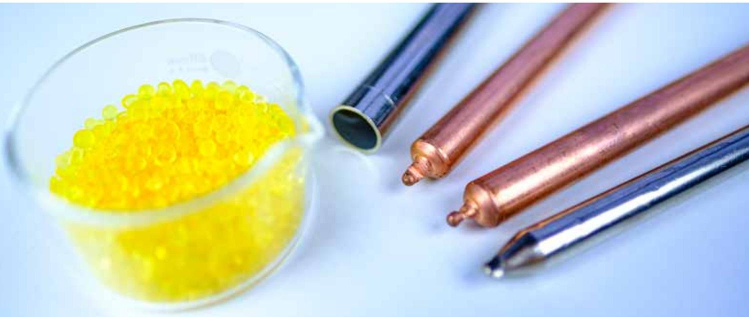
*Mithilfe wasserbindender Sorbentien entwickeln wir neue Konzepte für Heatpipe-basierte Wärmeschalter.*
