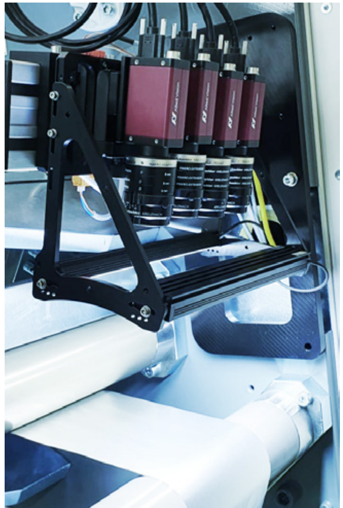
Sichere Rückverfolgung auch nach der Vereinzlung: In der Bahnwarenproduktion lassen sich Prozessdaten dank der Track & Trace Fingerprint-Technologie mit einem bestimmten Abschnitt eines Coils verknüpfen.
