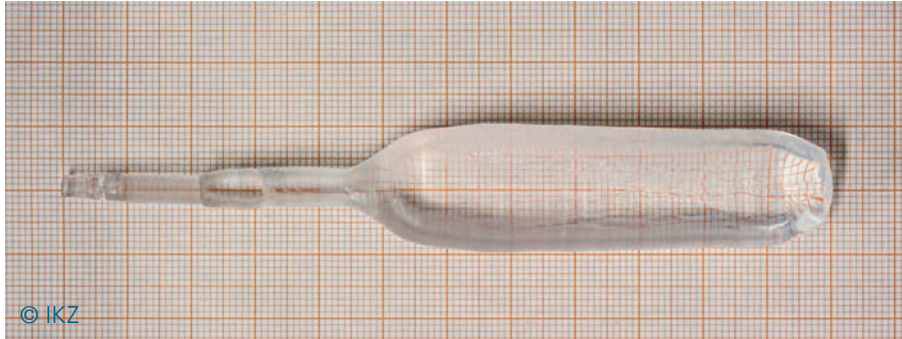
Optimal für Dauerstrich-VUV-Lichtquellen: Ein am IKZ gezüchteter BaMgF 4 -Kristall mit außergewöhnlich breiter Transparenz im Wellenlängenbereich von 130 nm bis 13 µm.
