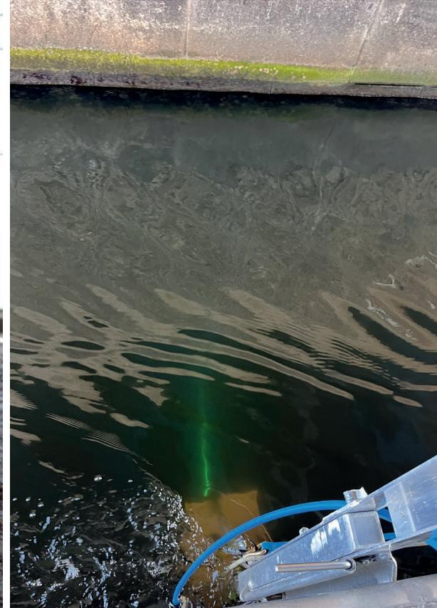
Das goldfarbene »Underwater LiDAR System ULi« erfasst Strukturen im Wasser per Laserdistanzmessung auf wenige Zentimeter genau.
