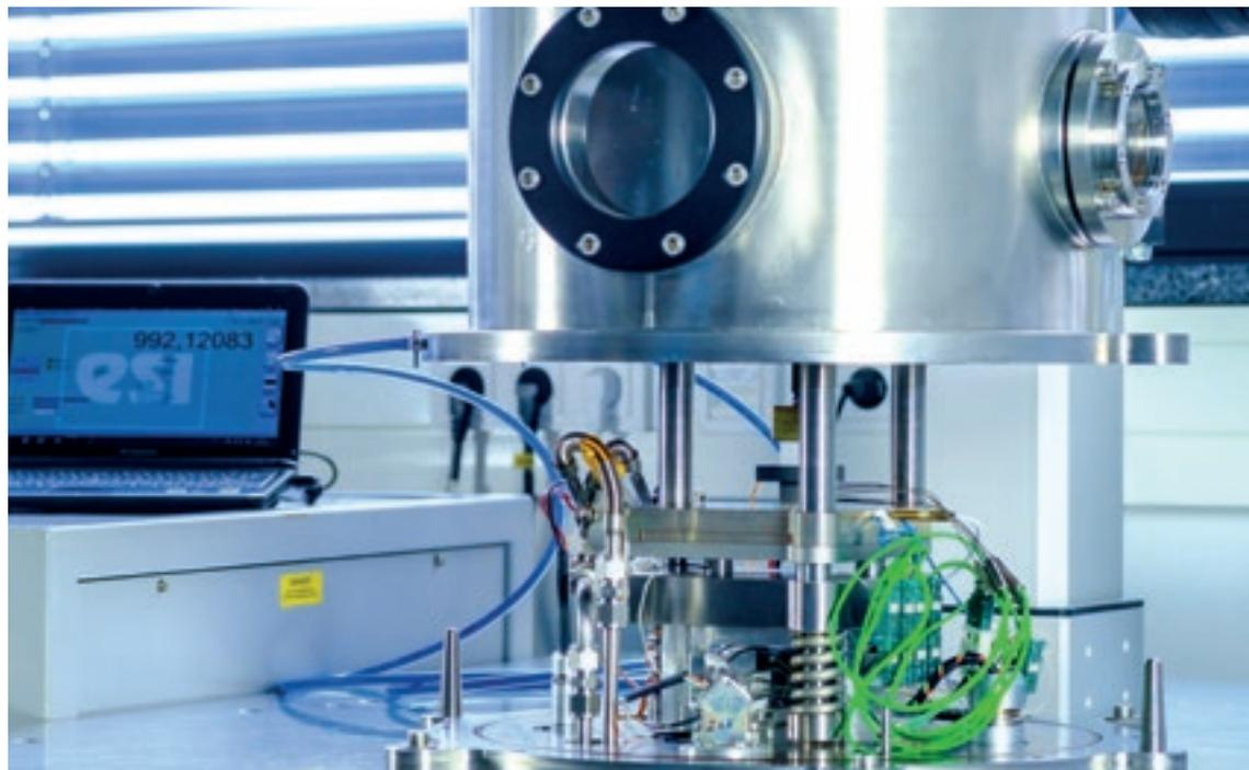
*Neuer Messplatz für Peltier-Module: Hier charakterisieren wir Module unterschiedlicher Größe und Bauformen.*
