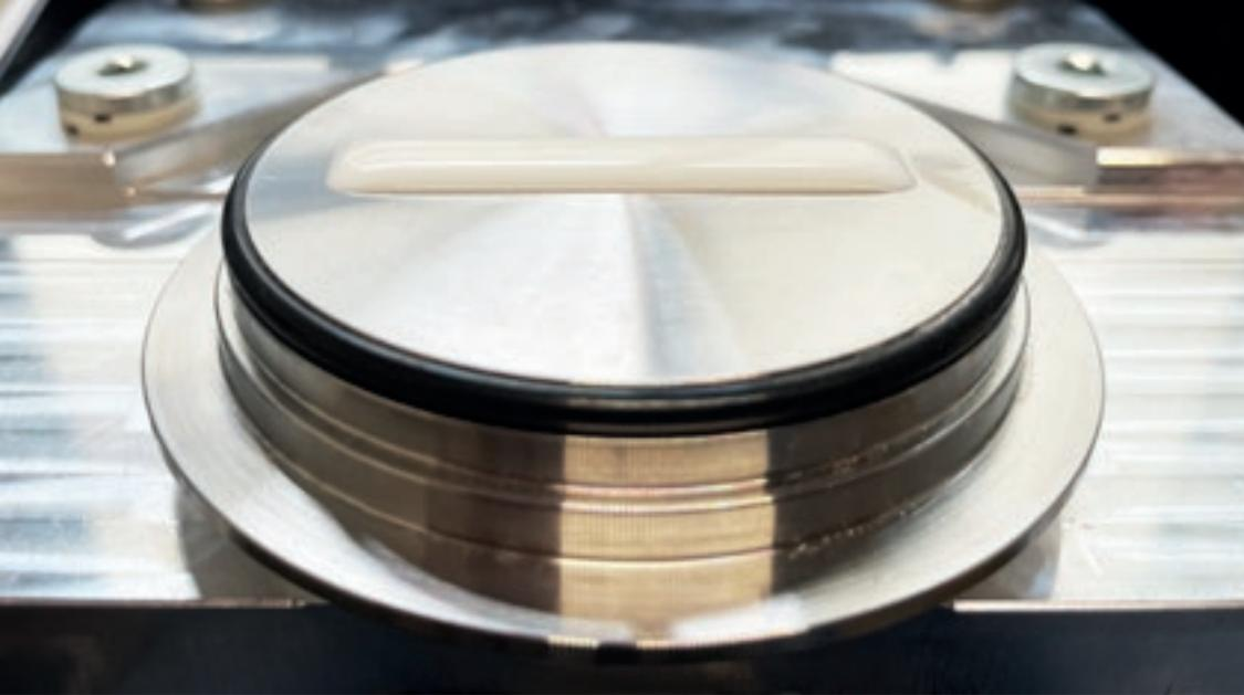
*Milch auf der Oberfläche eines ATR-Sensors. Solche Sensoren sollen in Zukunft aufwändige Labormessungen überflüssig machen.*
