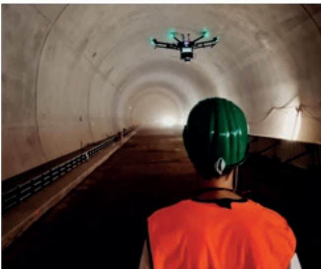
*Auf leicht getrimmt und abgehoben: Das Gehäuse des kaum mehr als zwei Kilogramm schweren Laserscanners für die Tunnelinspektion besteht aus Carbonfasern.*
