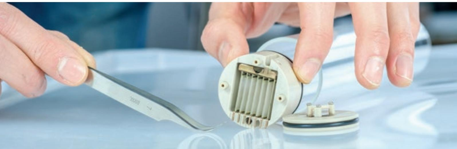
*Elektrokalorische Komponenten: Für eine besonders effiziente Wärmeabfuhr wurden keramische Mehrlagenkomponenten in eine Heatpipe integriert.*
