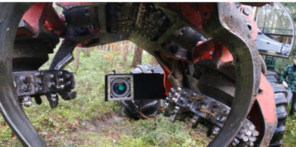
Das Track & Trace Fingerprint-System nimmt die Schnittflächen der Baumstämme direkt am Vollernter auf.
