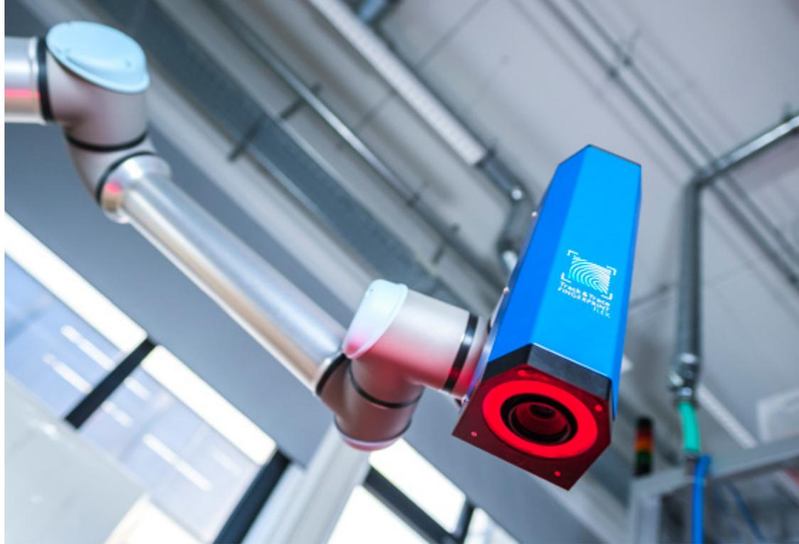
*Track & Trace Fingerprint Flex am Roboterarm: Das System identifiziert Bauteile und kann an beliebigen Orten im Produktionsumfeld eingesetzt werden.*
