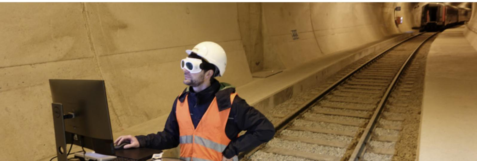
*Unter der Oberfläche einer Betonwand können sich Hohlstellen oder Abplatzungen verbergen. Solche Fehlstellen lassen sich jetzt mithilfe eines Laserpulses aufspüren.*
