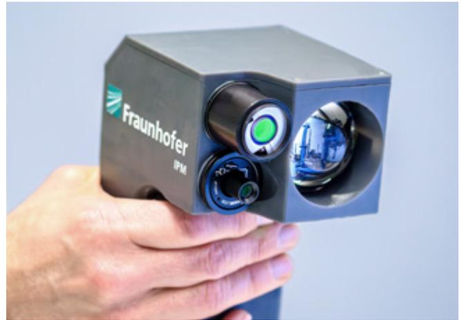
Ein handgehaltenes Laserspektrometer für die Gasferndetektion misst Ammoniak-Leckagen berührungslos aus bis zu 50 m Entfernung.
