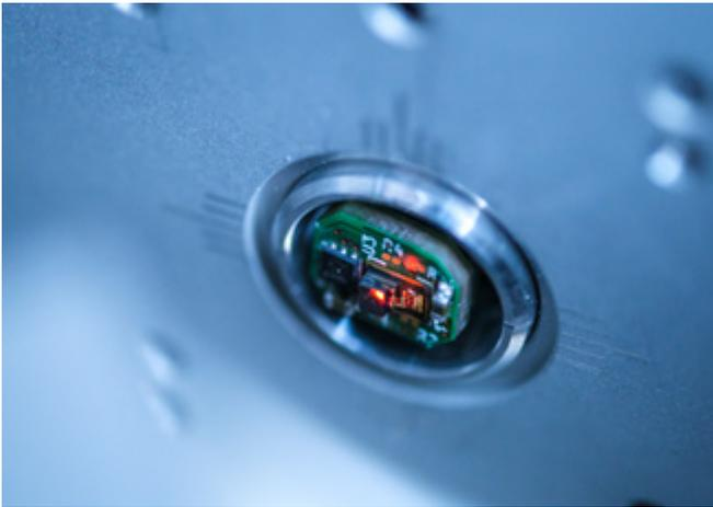
Ein photoakustischer Detektor für CO<sub>2</sub> wird in einem Spektrometeraufbau charakterisiert.
