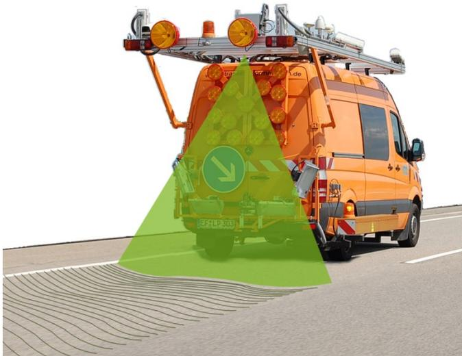
Ein am Fraunhofer IPM entwickelter Laserscanner ist auf einem Messfahrzeug des Industriepartners Lehmann+Partner montiert. Er erfasst Straßenunebenheiten in einer Größenordnung weniger als 0,3 mm. Die Laserscanner-Technologie wurde nun mit dem GIS Award der GDI –Sachsen e.V. honoriert.
