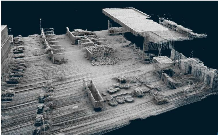
**Nicht einmal zehn Minuten benötigt der fliegende Laserscanner, um die komplexen Strukturen eines Areals von mehreren hundert Quadratmetern zu erfassen, auszuwerten und zu visualisieren.**
