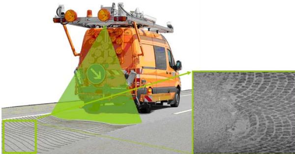
**Laserscanner erfassen das Höhenprofil von Straßenoberflächen millimetergenau – auch bei Fahrgeschwindigkeiten von bis zu 80 km/h. © Lehmann + Partner /Bildmontage Fraunhofer IPM**
