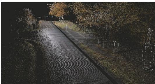
3D-Punktwolken sind die Grundlage für eine effiziente Planung beim Ausbau von Infrastruktur. Die Daten werden mithilfe optischer Messtechnik besonders effizient erfasst. © Fraunhofer IPM
