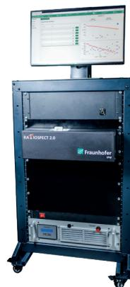
Das Messsystem Ratiospect 2.0 erlaubt eine viel schnellere, genauere und empfindlichere Gehaltsbestimmung lichtempfindlicher Pflanzenproteine als bisher. © Fraunhofer IPM
