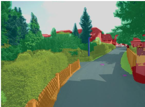
Aus Kamerabildern und Laserscanner-Daten wird eine texturierte Punktwolke erzeugt. Ein KI-basierter Algorithmus erkennt, klassifiziert und kodiert darin einzelne Objektklassen farbige. Die Objektinformationen fließen automatisiert in intelligente Planungskarten ein, die als Grundlage für Infrastrukturplanungen dienen. Copyright: Fraunhofer IPM
