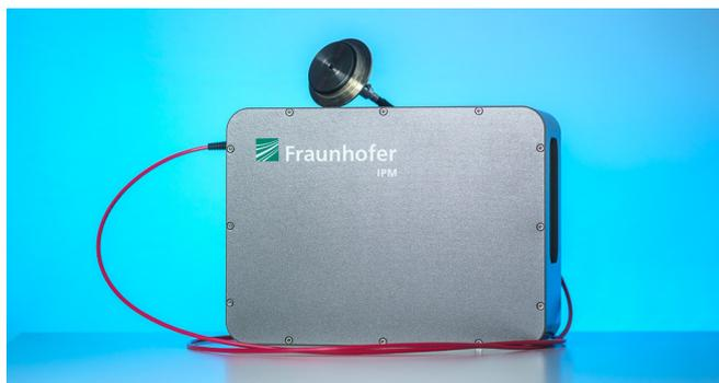
**F-Fiber: Der faserbasierte Fluoreszenz-Sensor ermöglicht den Einblick in geschlossene Behälter – ohne vollen optischen Zugang. Das millimeterfeine Faserende wird über einen Flansch in die Behälterwand integriert und misst dort den Grad des Foulings, sodass Reinigungsroutrinen dynamisch angepasst werden können.**
