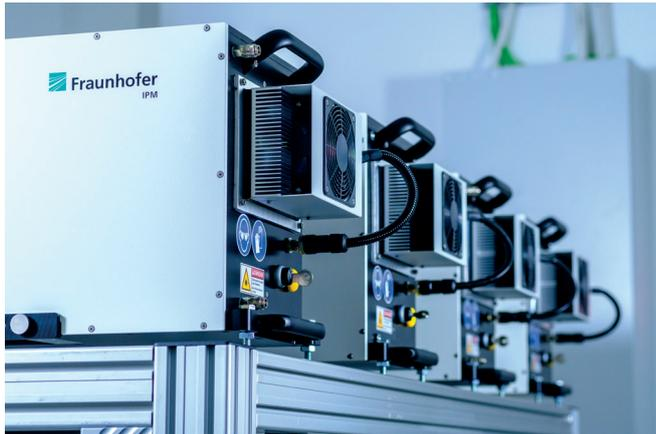
**Vier F-Scanner – hier noch im Entwicklungslabor bei Fraunhofer IPM – kontrollieren anhand des Fluoreszenzsignals von Trockenschmierstoffen deren Verteilung auf der Aluminiumoberfläche – orts aufgelöst auf vier Meter breiten Aluminiumblechen in der Fertigungslinie.**
