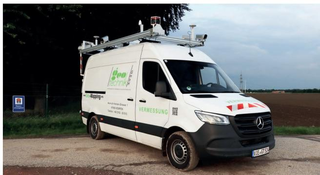
**Noch leistungsfähiger als die Vorgängermodelle: Der Vermessungsdienstleister Geotechnik GmbH nutzt seit dem Frühjahr das neueste Modell des am Fraunhofer IPM entwickelten Mobile Urban Mapping Systems MUM. Bild: Pascal Kügler / Geotechnik GmbH**
