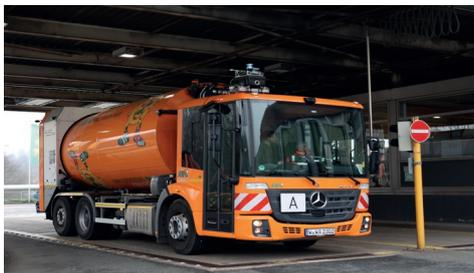
**Müll- und Messfahrzeug gleichzeitig: Mit der kompakten und robusten Sensorbox auf dem Dach wird jedes Fahrzeug zum Messfahrzeug.**
