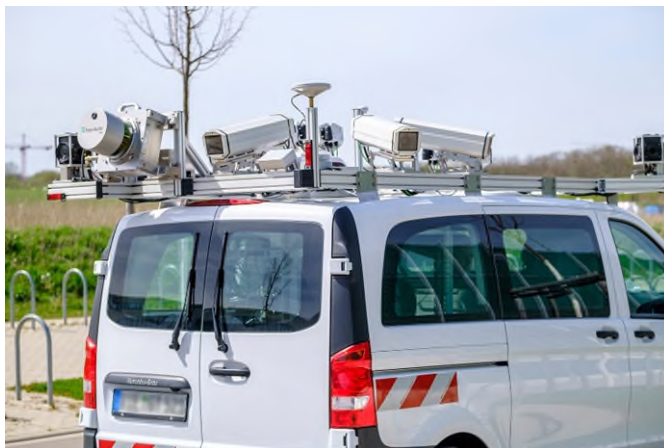
Abb. 4 Großes Messfahrzeug, ausgerüstet mit Kameras und Sensorik des Fraunhofer IPM
