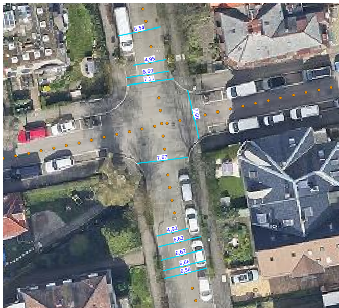
Abb. 2 Automatisiert abgeleitete Straßenbreiten als Überlagerung in einem geografischen Informationssystem
