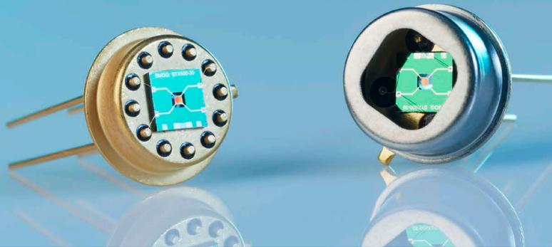
^ Mikrostrukturierter, modulierbarer IR-Strahler: Die emittierende Fläche ist frei im Chip aufgehängt.
