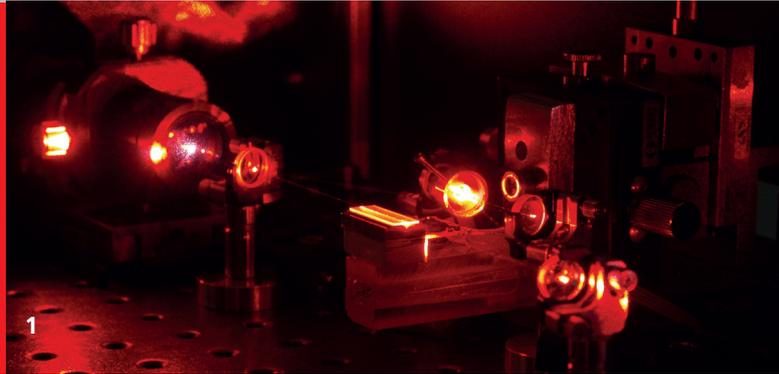
1 *Optisch Parametrische Oszillatoren (OPO) für den Dauerstrichbetrieb sind weit durchstimmbare Lichtquellen mit schmaler Linienbreite.*
