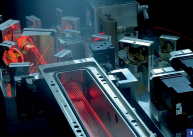
1 Optische Spektrometer mit Quantenkaskadenlasern können Lachgas sehr empfindlich nachweisen.
