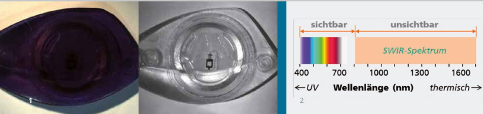
1 Mit einer gewöhnlichen Kamera ist die eingebettete Elektronik eines Schlüsselchips kaum zu erkennen (links). Eine SWIR-Kamera macht den Chip sichtbar (rechts).
