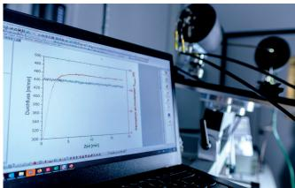
Der Heatpipe-Messplatz ist speziell für die Charakterisierung rohrförmiger Heatpipes ausgelegt. Heatpipes mit unterschiedlichen Durchmessern, Längen und Biegungen untersuchen wir für unterschiedlich einstellbare Kippwinkel und räumliche Orientierungen.
