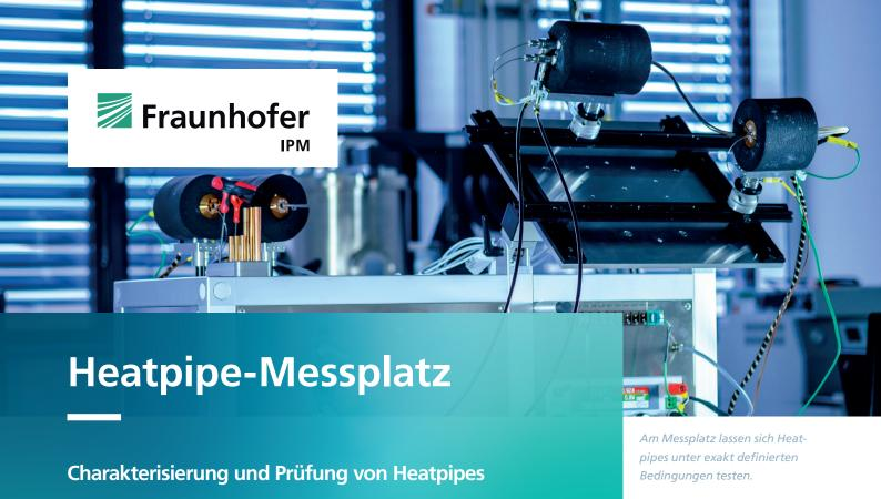
Wärmerohre, sogenannte Heatpipes, sind ein zentraler Bestandteil in vielen Systemen für die Kühlung und Entwärmung. Damit Heatpipes effizient und zuverlässig funktionieren, müssen sie optimal an die jeweiligen Einsatzbedingungen angepasst sein. Fraunhofer IPM entwickelt eigene Messplätze, um Wärmerohre unterschiedlicher Geometrie mit Blick auf Abmessungen, Wärmelasten oder räumliche Orientierungen zu testen und zu charakterisieren.
