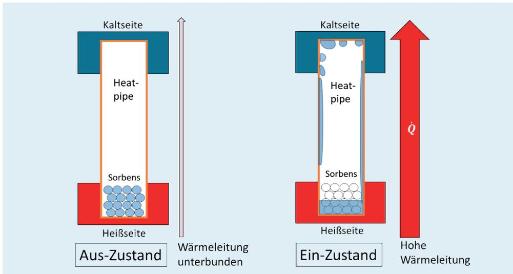
*Thermischer Schalter mit temperaturabhängiger Schaltbarkeit durch Sorbentien.*
