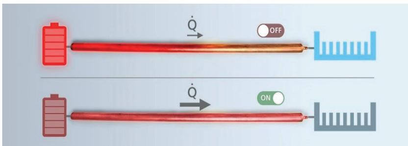
*Schaltbare Heatpipes sind kompakt und kommen ohne bewegliche Teile aus. Sie sind einfach integrierbar und versprechen sehr hohe Wärmetransportfähigkeiten.*
